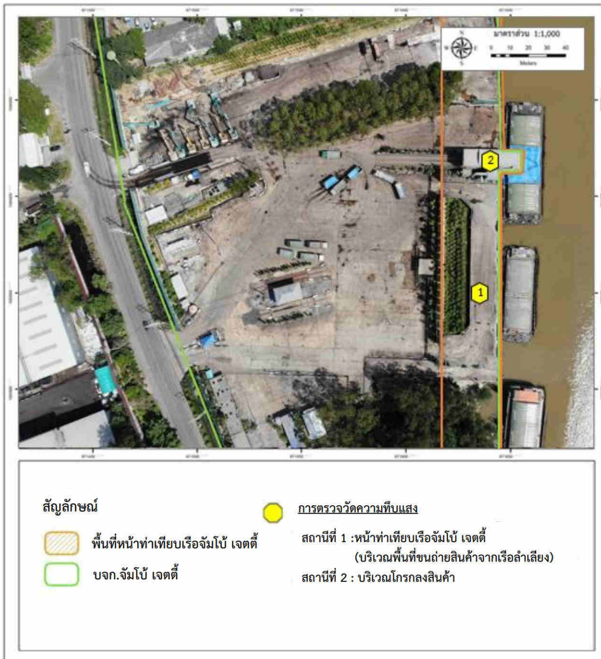
รูปที่ 3-2 สถานีตรวจวัดค่าความทึบแสงของฝุ่นละอองฟุ้งกระจายจากท่าเรือ (Smoke Opacity)
